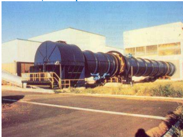
Figura 7-18 Instalație de compostare dinamică cu tambur de alterare
