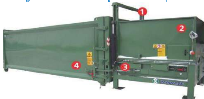
Figura 7-5 Sistem de compactare fix al deșeurilor
