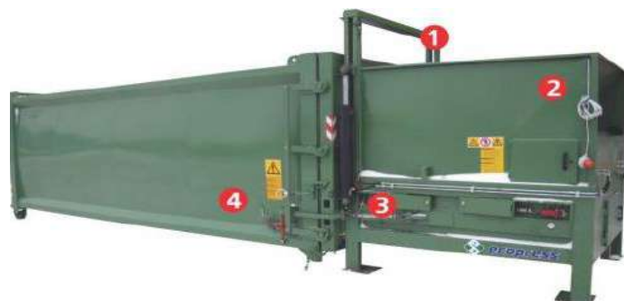
(1. ghilotină care ridică și coboară ușa containerului; 2. compactor propriu-zis; 3. sistem hidraulic de prindere și fixare a containerului compactor; 4. container)
